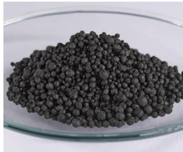
Staubfreie, kompaktierte Recycling-Carbonfasern, die sogenannten Fiberballs
