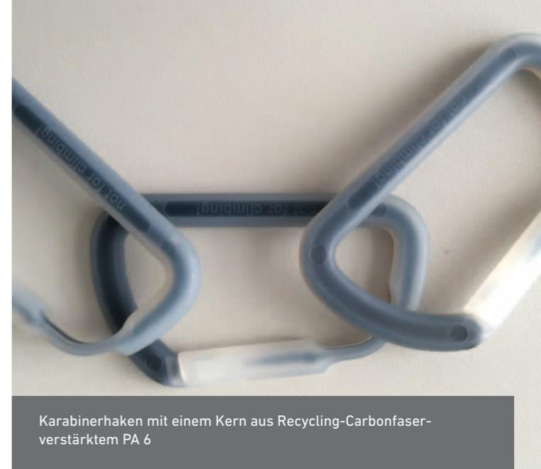
Karabinerhaken mit einem Kern aus Recycling-Carbonfaser-verstärktem PA 6
