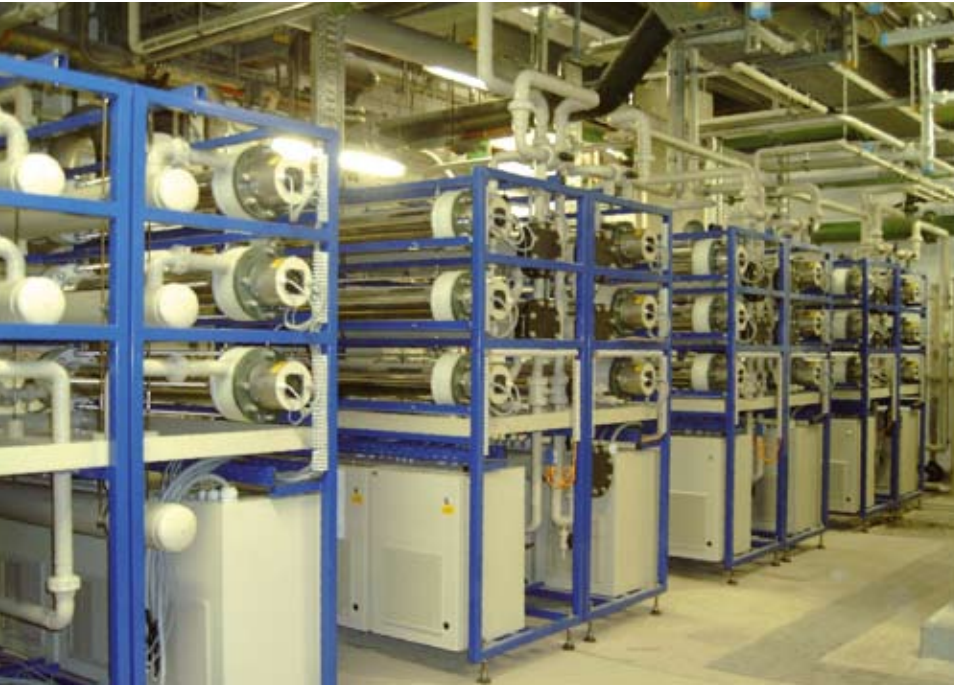
Enviolet® UV-Anlagen werden zur Behandlung von Prozessströmen, Wasser und Abwasser erfolgreich eingesetzt.
