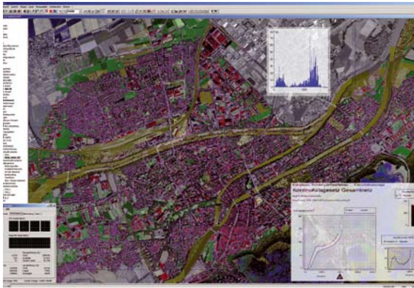
Das Kanalnetz der Stadt Landshut wurde über einen Zeitraum von 15 Jahren simuliert.
