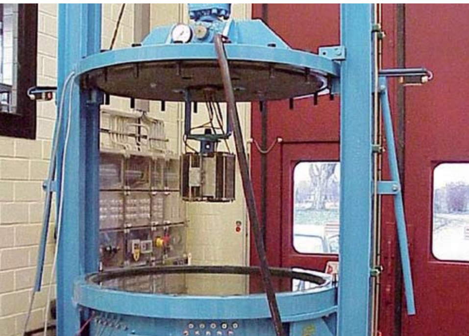
Modellbrunnen »Ursel« zur Simulation eines Vertikalfilterbrunnens
