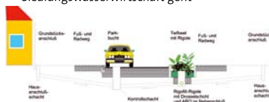
Schematische Darstellung eines Mulden-Rigolen-Systems im Straßenraum
