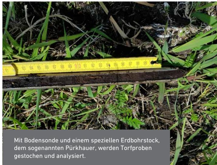
Mit Bodensonde und einem speziellen Erdbohrstock, dem sogenannten Pürkhauer, werden Torfproben gestochen und analysiert.
